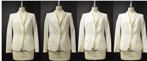
(a) no interlining (b) soft interlining (c) normal interlining (d) hard interlining
